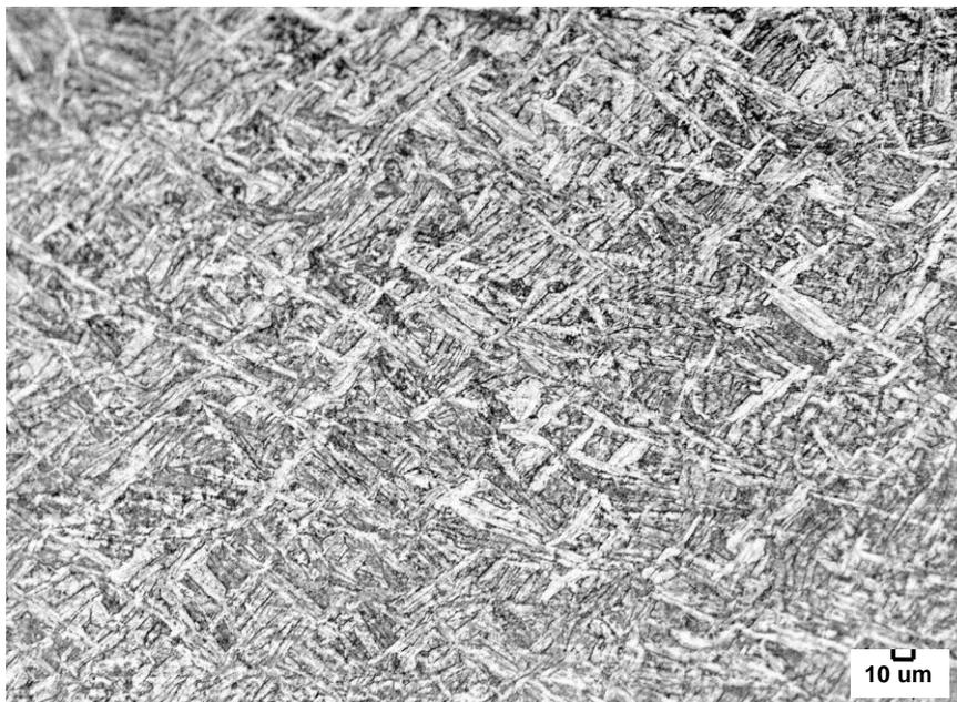
FIGURA 52 - Microscopia óptica da amostra 10.1 (fusão #10) após o tratamento termo-mecânico a 850 °C e laminação a **quente**, com morfologia característica de estrutura *Widmanstätten* da forma *basketweave*. Ataque: 50% H<sub>2</sub>O<sub>2</sub> + 25% HNO<sub>3</sub> + 25% álcool etílico + 2 gotas HF.
