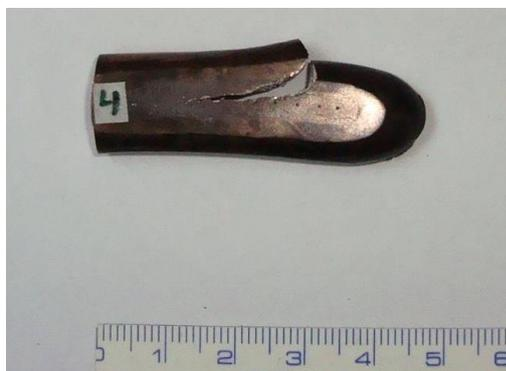
FIGURA 42 – Amostra 10.4 após a laminação a frio, onde pode-se notar a fratura longitudinal.
