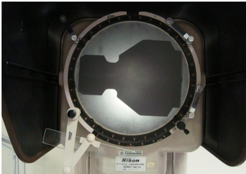
FIGURA 27 - Imagem projetada do tampão em perfilômetro óptico, podendo-se observar detalhes do seu contorno.
