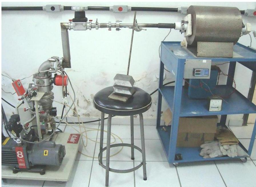
FIGURA 31 - Equipamento empregado na sinterização, constando do forno e tubo contendo a amostra, conectado ao sistema de vácuo.
