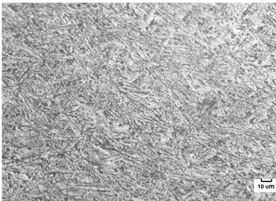
FIGURA 44 – Microscopia óptica da amostra da fusão #4 após o tratamento térmico (800 °C/1 h), contendo agulhas da fase  $\alpha$  dispostas numa morfologia do tipo *basketweave*. Polimento e ataque eletrolítico em ácido perclórico 70% e ácido acético glacial na proporção 1:10.
