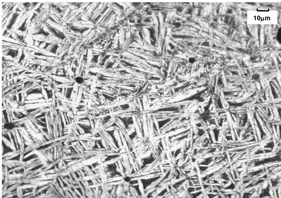
FIGURA 47 – Microscopia óptica da barra fundida do Zircaloy-4: lado final da barra (amostra F2), apresentando características morfológicas de microestruturas *Widmanstätten* do tipo *basketweave*. Polimento e ataque eletrolítico em ácido perclórico 70% e ácido acético glacial na proporção 1:10.
