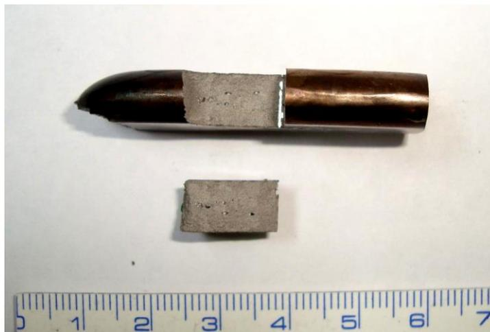
FIGURA 82 – Fotografia lateral da amostra 10.4 laminada a frio, notando-se o aspecto da trinca aberta.
