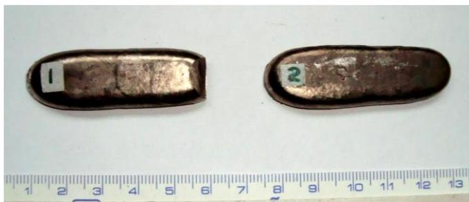
FIGURA 40 – Amostras 10.1 e 10.2 após a laminação a quente.
