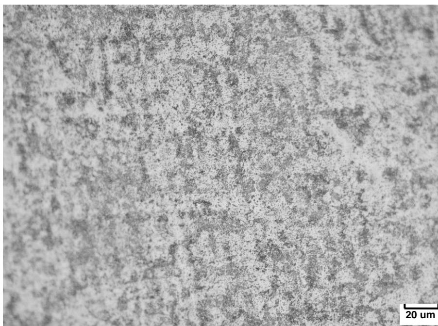
FIGURA 57 - Microscopia óptica da amostra da barra de Zircaloy-4, onde pode-se observar a estrutura equiaxial fina de fase  $\alpha$ . Ataque: 50%  $H_2O_2$  + 25%  $HNO_3$  + 25% álcool etílico + 2 gotas HF.
