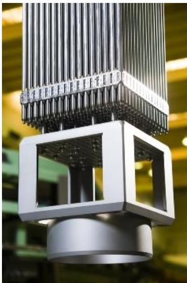
FIGURA 1 - Parte de um elemento combustível de um reator PWR [2].
