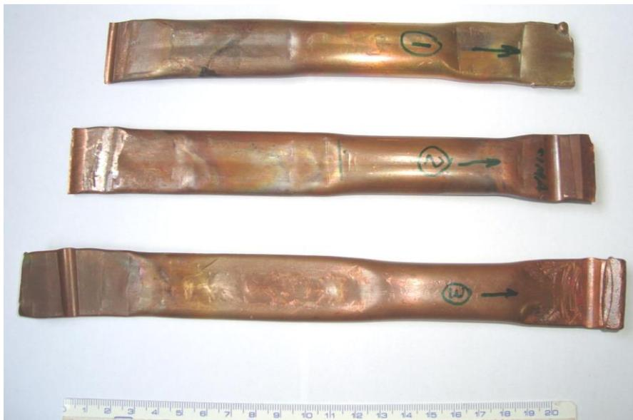
FIGURA 32 - Amostras encapsuladas em tubos de cobre.
