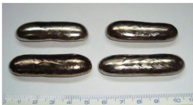
FIGURA 39 – Quatro barras de Zircaloy-4 obtidas na fusão #10 para tratamento térmico e laminação, apresentando aspecto uniforme e ausência de oxidação na superfície.
