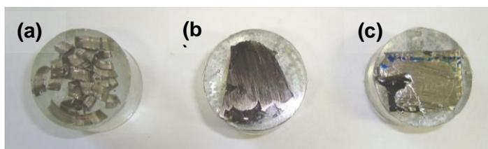
FIGURA 21 - Amostras embutidas em resina: a) na forma de cavacos; b) corte transversal do lingote; c) corte longitudinal.
