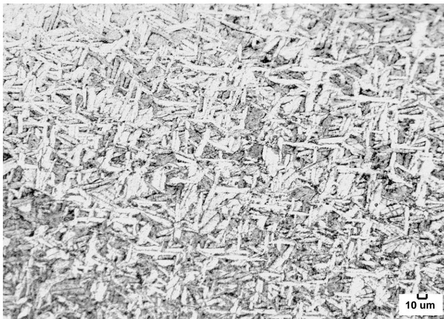
FIGURA 54 - Microscopia óptica da amostra 10.4 (fusão #10) após o tratamento térmico a 910 °C e laminação a **frio**, apresentando microestrutura típica de *Widmanstätten* da forma *basketweave*. Ataque: 50% H<sub>2</sub>O<sub>2</sub> + 25% HNO<sub>3</sub> + 25% álcool etílico + 2 gotas HF.
